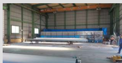
屋内塗装ブース
